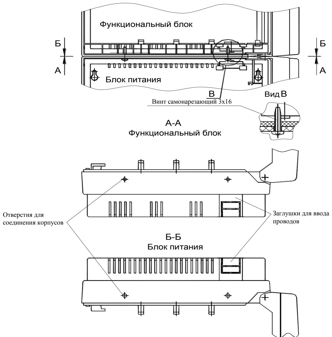
Рисунок А.2 – Соединение корпусов ППКП.
