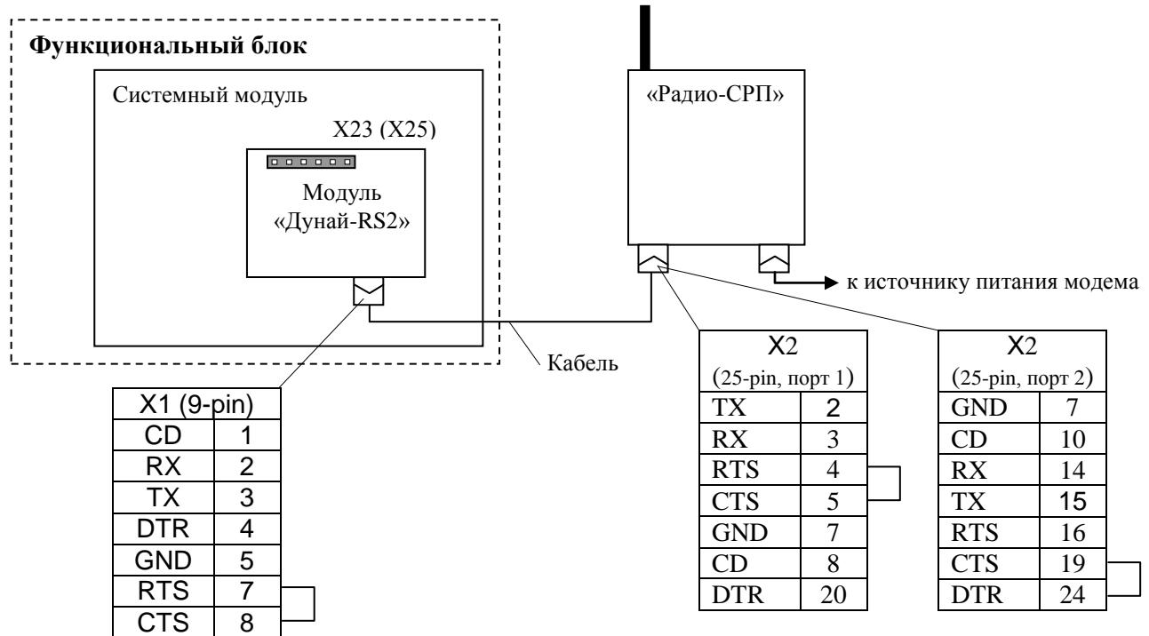
Примечание – Пользователь выбирает номер порта на модеме и выполняет распайку проводов кабеля одноименных сигналов по контактам соединителей.
