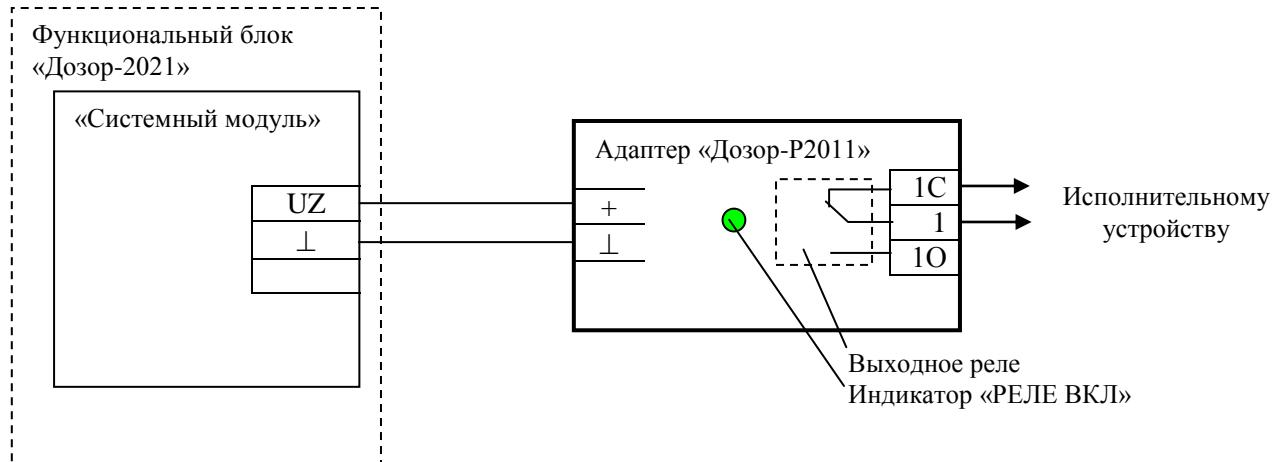
Рисунок Г.6 – Пример подключения адаптера «Дозор-Р2011» к выходу UZ
