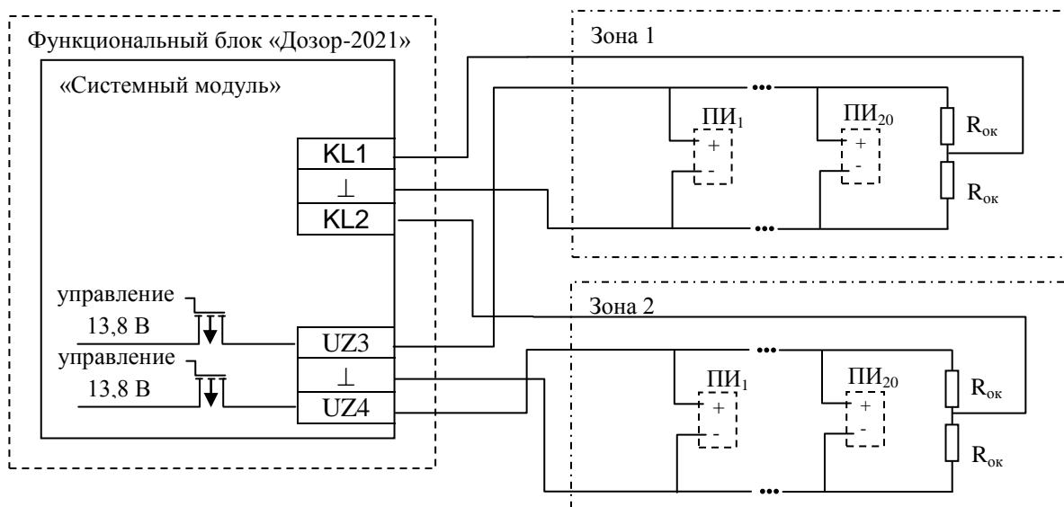
Примечание – Резисторы R<sub>ок</sub> типа SFR16 27 кОм ±1%. Допускается замена типа резисторов на C2-23.
