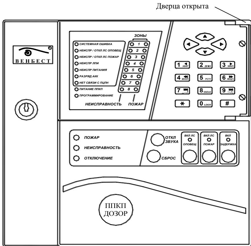
Примечание - В поле «ЗОНЫ», в столбцах «НЕИСПРАВНОСТЬ» и «ПОЖАР» устанавливаются индикаторы:
